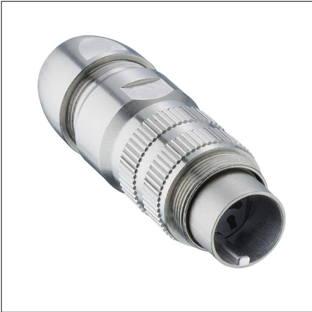
Next Generation – Stecker nach AISG-Spezifikation und IEC 61076-2-106, IP68, mit Schraubverschluss und Vibrationsschutz, Leergehäuse für die Aufnahme von Crimpkontakten, 360° geschirmt, optimierte Montage
